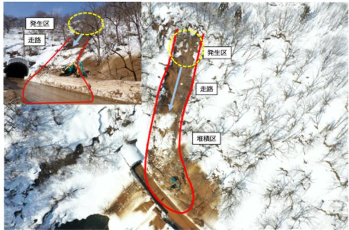
図13 雪崩発生斜面
