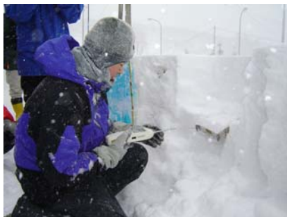
写真 7. 剪断強度測定
