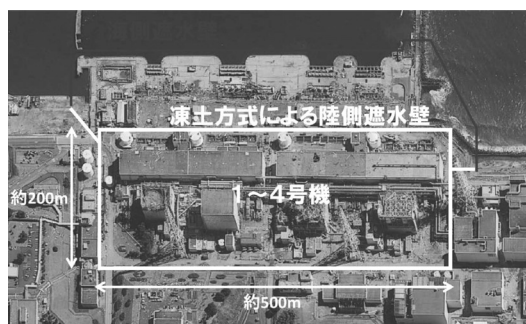
図 25 福島第一原発の凍土遮水壁の計画図 (平面, 断面) (経済産業省, 2013b).
