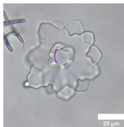
図1 人工十二花結晶 ( \phi: 26.6^\circ )
