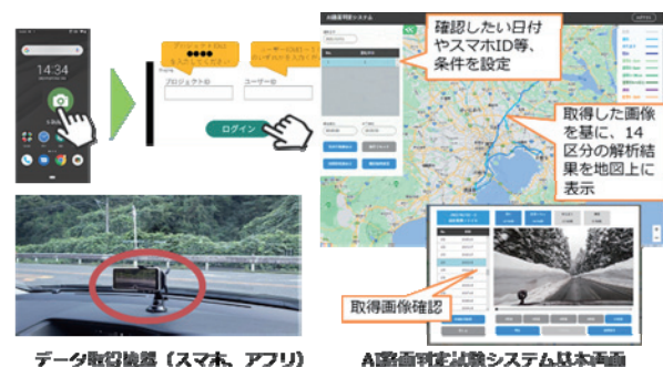
図2 スマホ AI 路面判定試験システムの概要。
