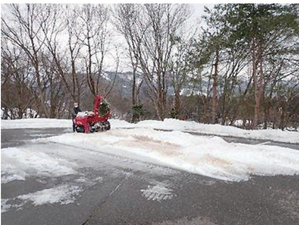
図-1 小型除雪機を使用した積雪路面作成の様子
