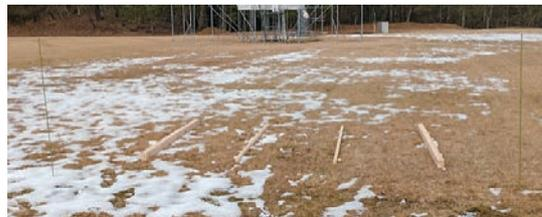
図2 マルチライシメータ枠を擬似した柱の設置
