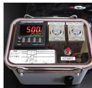
図 1 降雪結晶観測装置。左:小型ベルトコンベア装置。左手前のギア付きモーター(12V 駆動)でゴム製のベルトを動かす。右:デジタルツインタイマーユニット。市販のツインタイマーとディレーリレー2台でコンベア ON/OFF, カメラシャッターを作動させることができる。
