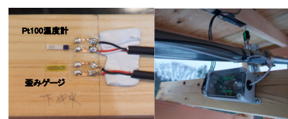
図2: 歪み測定用の歪みゲージ（左）と計測器と共に垂木に設置したところ（右）
