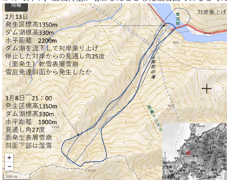
図1 雪崩発生状況
