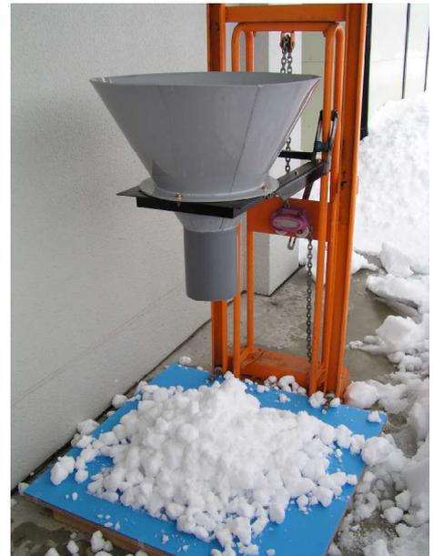
図1 注入式安息角測定器
