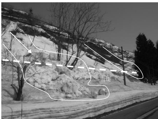
図 3 柿ノ木地区の雪崩 (破線が雪堤位置)
