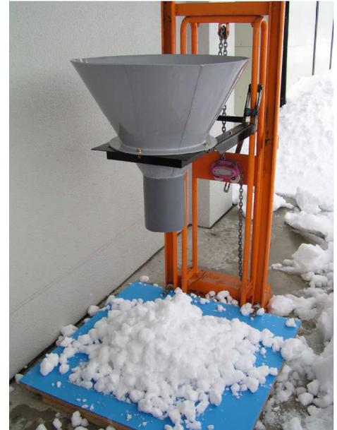
図1 注入式安息角測定器
