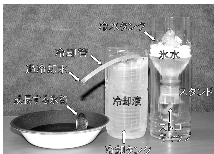
図-1 ペットボトル過冷却水生成装置
