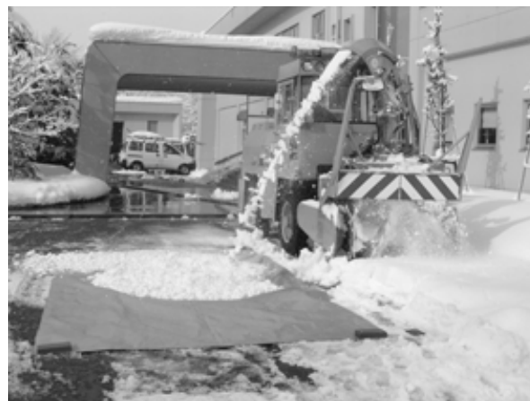
図 1 ロータリ除雪車の投雪状況
