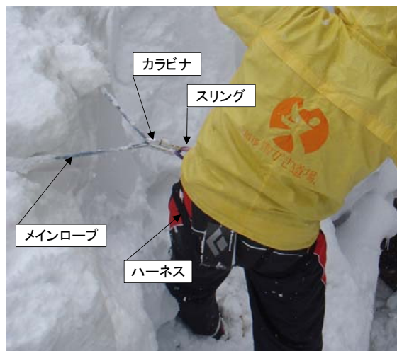
図2 ハーネスとメインロープの接続
