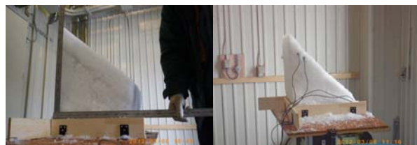
図2 振動による積雪の破壊
