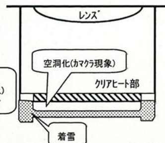
図2 信号機フードの断面略図
