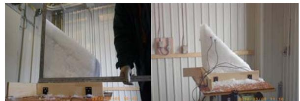
図2 振動による積雪の破壊
