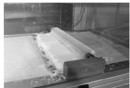
図2 粒子供給装置
