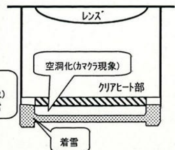
図2 信号機フードの断面略図
