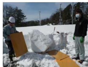
図1 積雪サンプルの切出し
