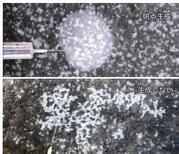
図 3 空気注入による斑点生成実験
