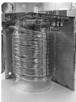
図2 発熱対策を施したRFコイル
