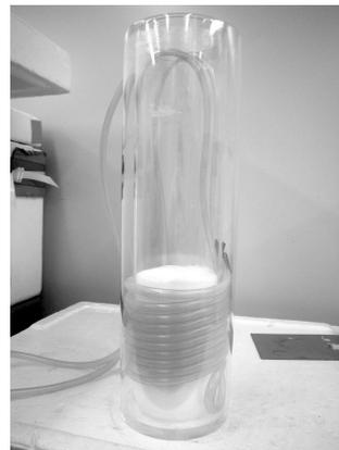
図2 積雪試料水冷装置
