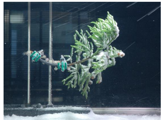
図1 実験終了直前の着雪状況 (風速9m/s)
