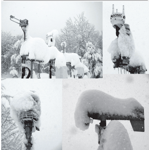
図1 観測1の状況(2014年12月14日12時の顕著な着雪時)。(a)全体、(b)超音波式、(c)一体型、(d)風車型。
