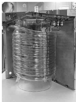
図2 発熱対策を施したRFコイル
