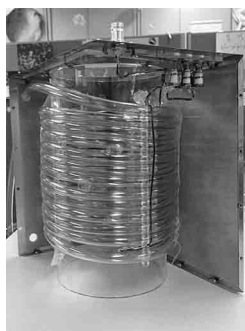
図2 発熱対策を施した RF コイル
