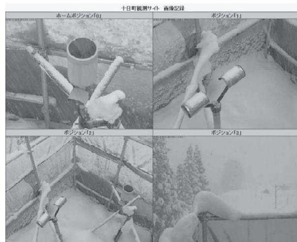
第2図 Web カメラによる SPOS 着雪モニタリング画像の例
