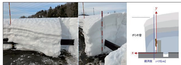
図6 一般道路の雪堤断面の例
