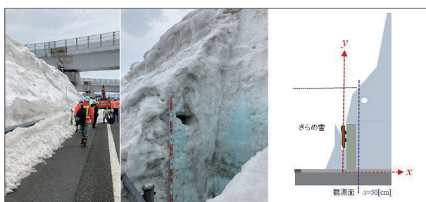
図5 高速道路の雪堤断面の例 ④
