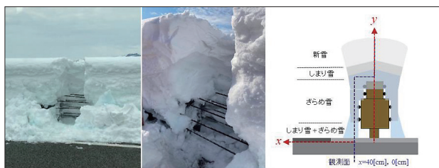
図2 高速道路の雪堤断面の例 ①
