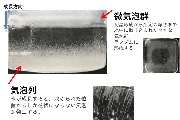
図2 氷に析出する気泡の種類
