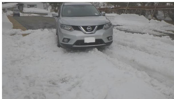
図-3 2WDでのスリップの様子
