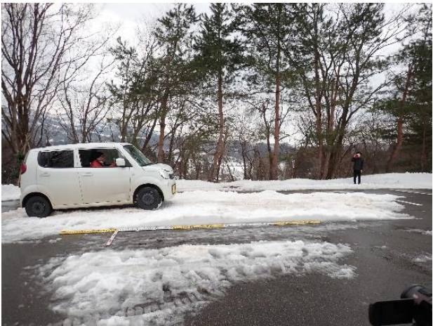
図-2 走行速度を遅くしたときのスタック状況
