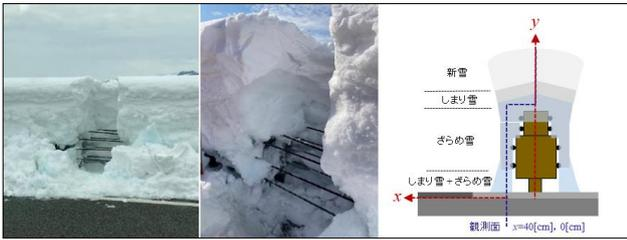
図2 高速道路の雪堤断面の例 ①
