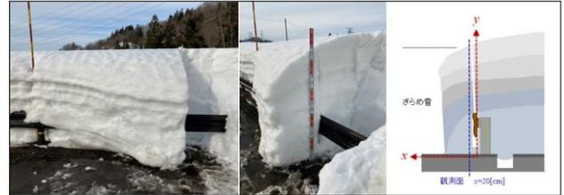
図6 一般道路の雪堤断面の例
