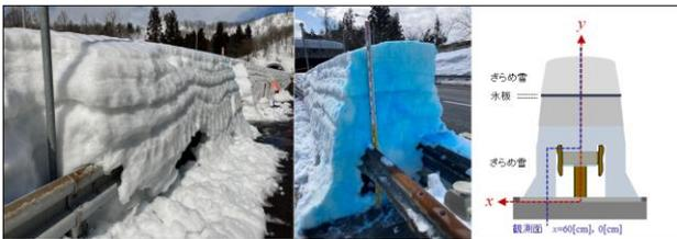
図3 高速道路の雪堤断面の例 ②
