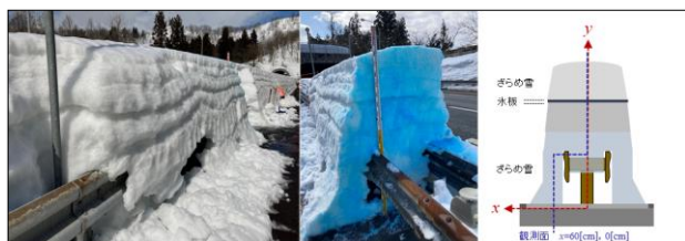
図3 高速道路の雪堤断面の例 ②
