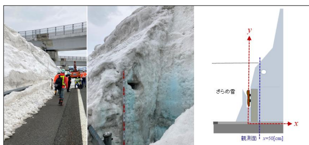
図5 高速道路の雪堤断面の例 ④
