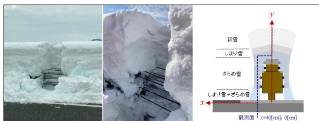
図2 高速道路の雪堤断面の例 ①
