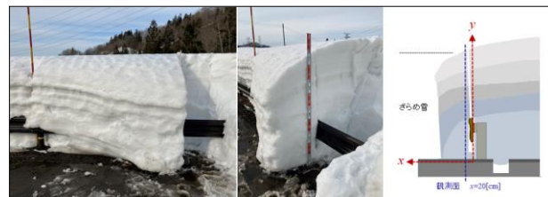
図6 一般道路の雪堤断面の例
