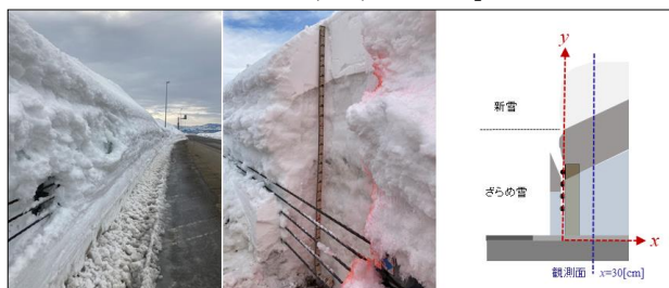
図4 高速道路の雪堤断面の例 ③
