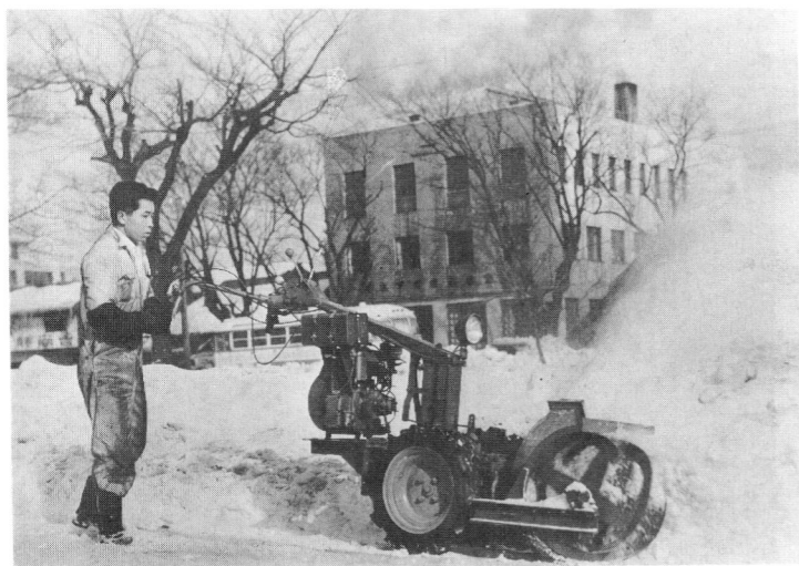
昭和33年 2月 創成川で試運転のロータリー式除雪機 (北海道新聞社提供)
