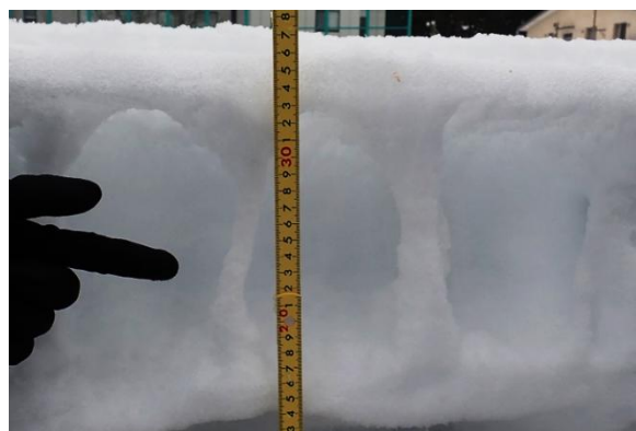
図 1 積雪内に形成された「凍結した水みちの痕跡」(2025 年 3 月 6 日, 北見)。
