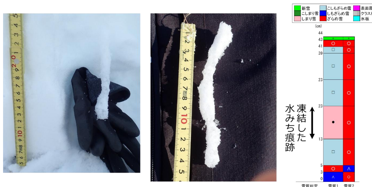
図8 帯広における凍結した水みちの痕跡. 2025年2月4日の大雪に伴う特徴がみられる.
