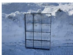
図2 模擬安全格子 (1メッシュ: 238×238mm)
