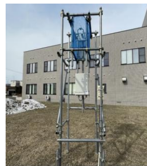
図 1 大学敷地内に設置したディストロメーター
