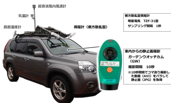
図1 移動気象観測車とインターバルカメラ
