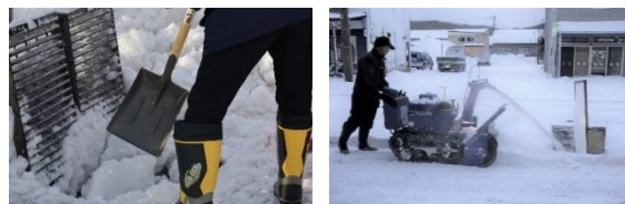
図 10 雪砕き作業と汎用自立型流雪溝投雪補助装置（古丹別地区流雪溝は公式に機械投雪可）
