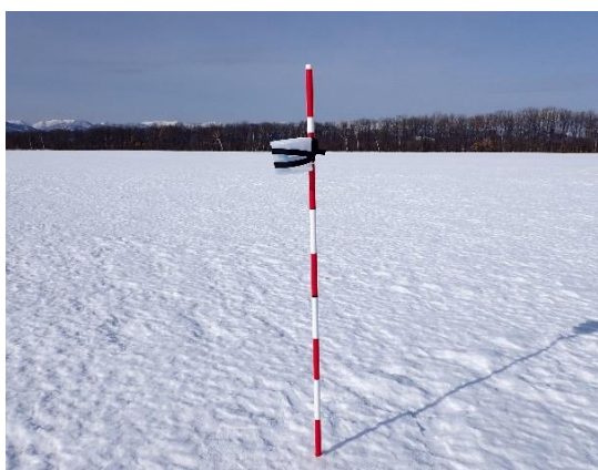
図 4 大気降下物採取用の円柱状容器
