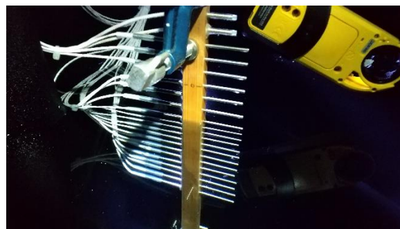
写真 2 温度プロファイル計と携帯型気象計 秒毎に静止画像として記録した。
