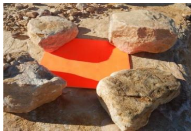
図4 観測域の岩盤上に設置した地上基準点。
