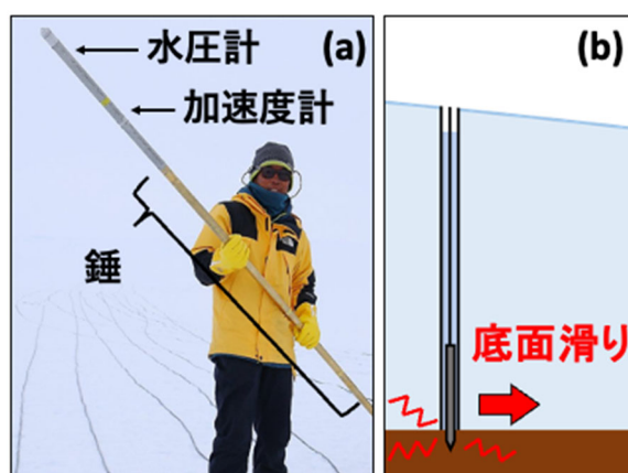
図1 (a) 開発した底面滑り観測測器。(b) 掘削孔を用いた底面滑り観測測器の設置イメージ。
