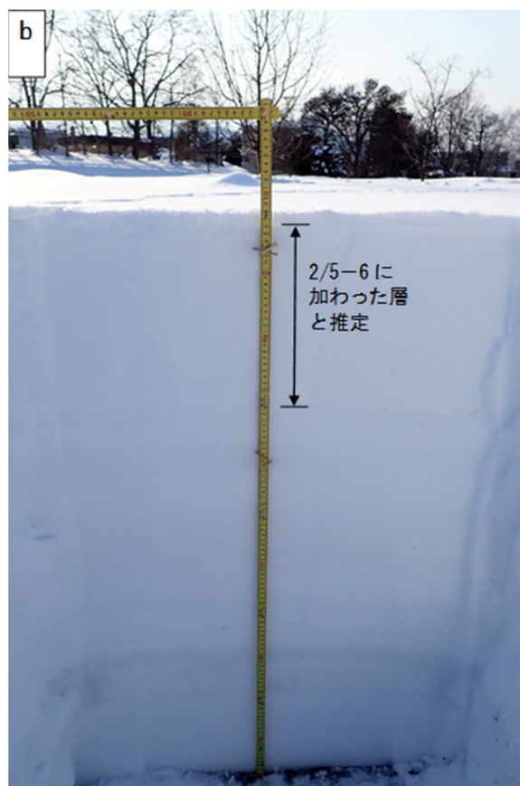
図2 札幌月寒公園での積雪断面観測結果。 (a) 積雪層位図、(b) 積雪断面写真。観測実施日：2022年2月12日。
