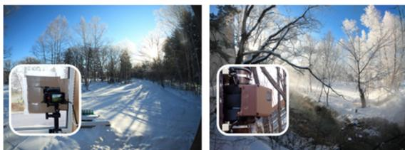
図1 定点カメラと設置地点の外観
