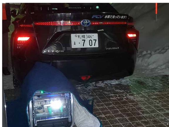
写真5 水素燃料電池車と電力供給ユニット
