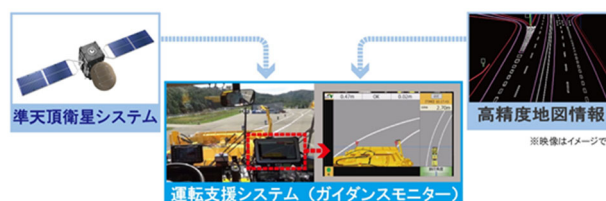
図 2 運転支援システムの概要
