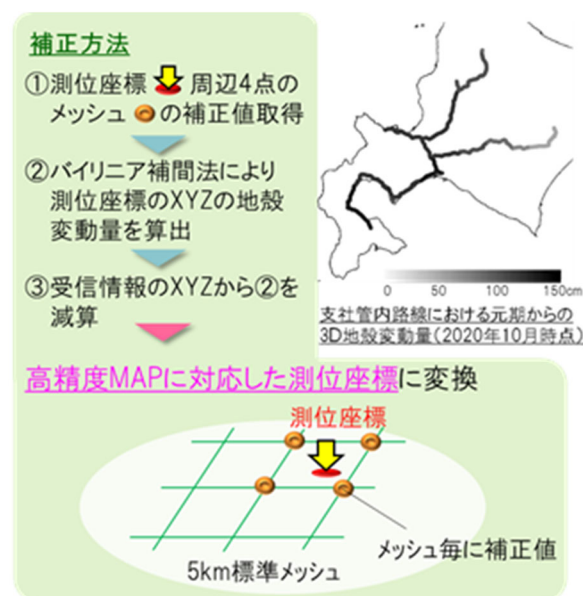
図6 地殻変動補正のイメージ
