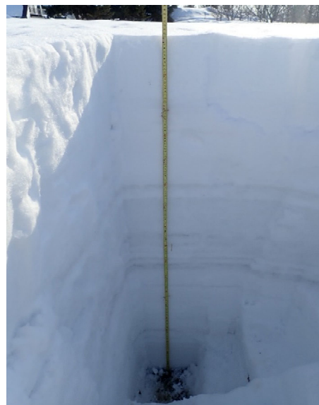
図 2 2021 年 3 月 5 日 岩見沢の積雪断面 (積雪深: 181cm, 積雪水量: 702mm)
