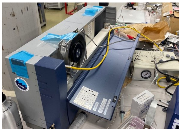
図1 使用したガスクロマトグラフ装置
