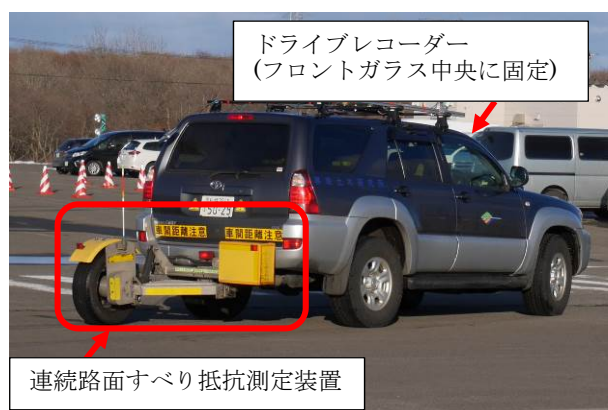
図 1 路面雪氷状態計測車両
