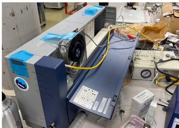
図1 使用したガスクロマトグラフ装置
