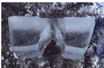
図6 亀裂断面のアーチ型構造、氷板下部は透明であり図1に示されているような「微小クラック」は存在していない。
