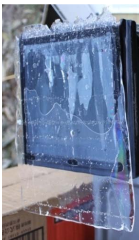
図 12 図 8 と同じ氷の断面，氷厚約 22.5 cm の氷板上部の結晶構造をみているが，この場合キャンドルアイスの結晶構造 3) を示している．(2019 年 4 月 1 日池の湯沖採氷サンプル)
