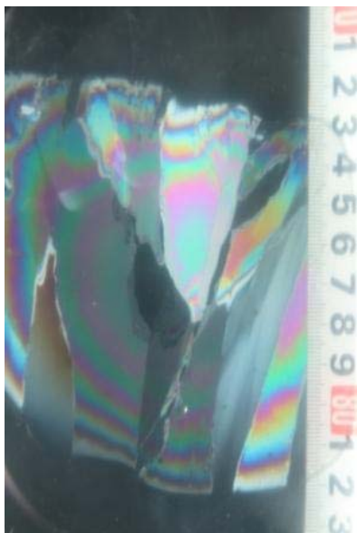
図 16 諏訪湖，舟渡川河口付近の湖面に於いて採取した，湖氷断面の偏光写真，この場合キャンドルアイスの結晶構造 3) を示している．微小クラックの発生は認められない．
