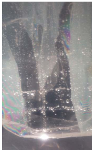
図 15 諏訪湖，舟渡川河口付近の湖面に於いて採取した，湖水サンプルの断面下部の偏光写真，水平縞は気泡層である．微小クラックの存在は認められない． (2018 年 2 月 15 日採氷サンプル)
