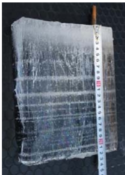
図 11 図 8 の領域の氷の断面，多重の気泡層を含む領域の例であるが，結晶境界の融解ライン 3),4) 以外，微小クラックの存在は認められない． (2019 年 4 月 1 日池の湯沖採氷サンプル)
