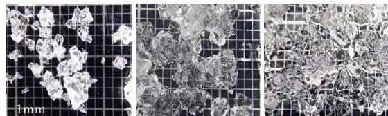
図2 作製した雪試料の結晶写真 (左から乾雪, 湿雪, スラッシュ)
