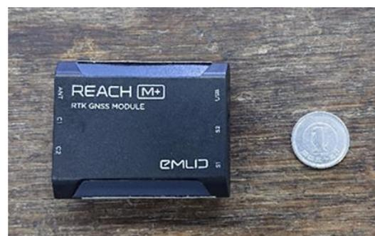
図3 GNSS機器を装着したPhantom4とRTK GNSS機器であるReach M+
