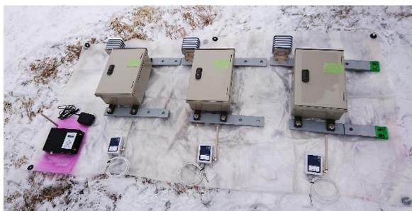
図2 LPWA式温度センサおよび親機の写真
