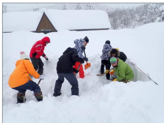
図3 旭岳ビジターセンター前駐車場における積雪断面観測。積雪深は約2 m。
