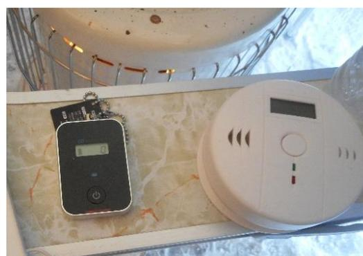
図3 一酸化炭素濃度チェッカー (左) と、一酸化炭素警報機 (右)
