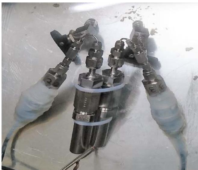
図 1 恒温水槽に沈めた耐圧容器と圧力計。
