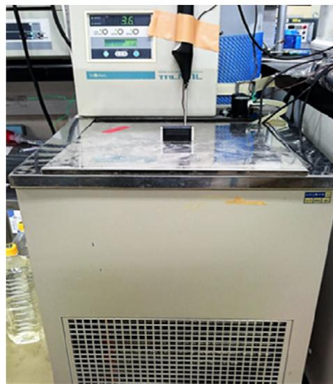
図 2 本研究で使用した恒温槽。
