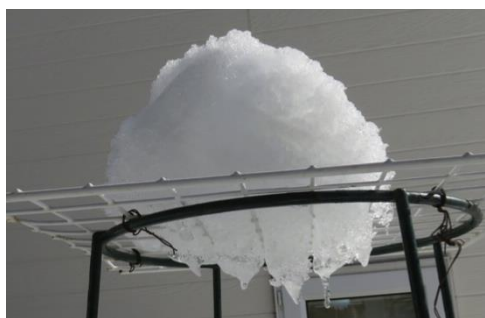
図 5 格子の落雪防止実験
