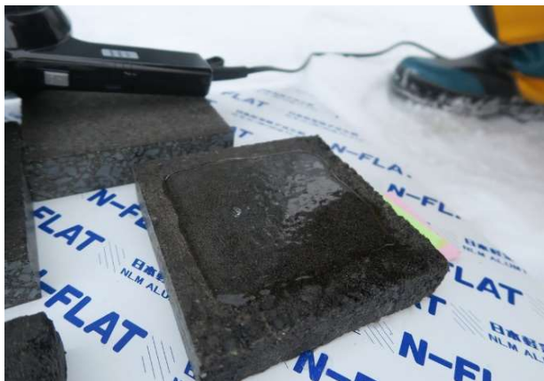
図 2 作製した氷膜路面
