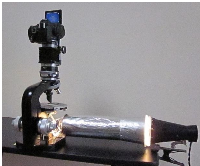
図 2 装置全体の概観。一般的な生物顕微鏡の接眼部にバリアングル液晶モニター付きのデジタルカメラを搭載。
