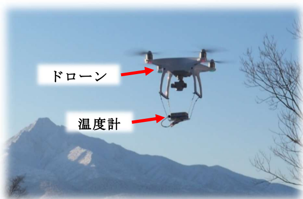
図4 温度計を吊り下げたドローン
