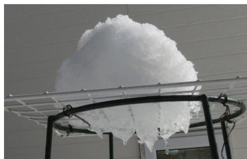
図 5 格子の落雪防止実験
