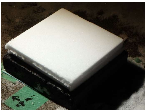
図 4 作製した圧雪路面
