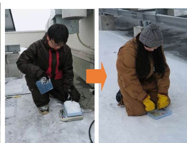
図 5 圧雪の作製 (左：重量計測，右：押し固め)
