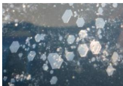
図9 透明氷内部の六角形の空像 気泡は無い
