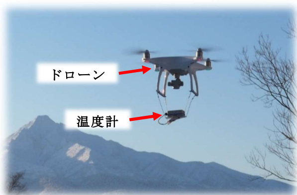
図4 温度計を吊り下げたドローン
